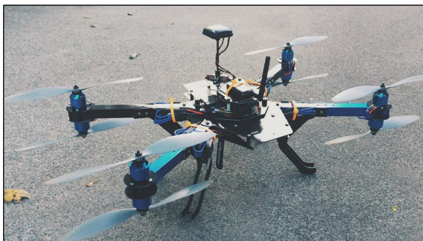
Montage du récepteur GPS sur un mât à l'écart des interférences électriques
